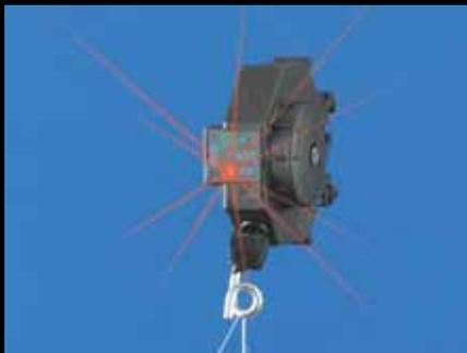
Dispositivo AST per la compensazione automatica ed elettronica di strappi o extratensioni del filato.
